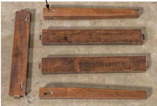
mortis & tenon construction
